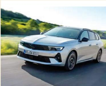
Yeni modifikasiya 136 at gücündə 1,2 litrlik üç silindrlı benzin turbo mühərriki və 28 at güclü elektrik mühərriki özündə birləşdirən 6 pilləli qoşa mufalı transmissiya ilə birləşib. Litium-ion batareyası əyləcə zamanı doldurulur. Batareya sol ön oturmaqan altında yerləşir, bu da baqaj həcmi-nin dəyişməz qalmasına imkan verir.
